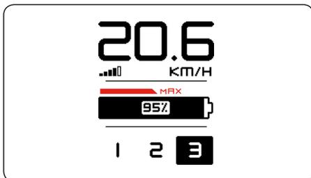
Per la vostra sicurezza una piccola parte dell'energia della batteria viene risparmiata per poter mantenere attive le funzioni base della vostra Stromer. Quando la batteria è scarica e l'assistenza alla pedalata si disinserisce, la luce e il display continuano a funzionare per circa un'ora.
