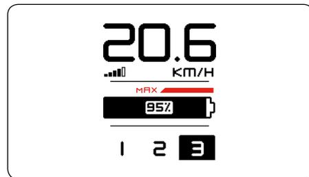
En mode frein moteur, la batterie se recharge et la barre de couleur foncée s'affiche de gauche à droite.
