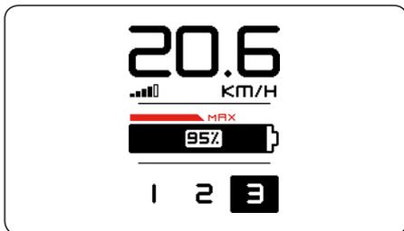
Pour votre sécurité, le Stromer ne laisse pas la batterie se décharger complètement, conservant un peu d'énergie pour pouvoir maintenir les fonctions de base. Lorsque la batterie est vide et que l'assistance s'interrompt, les feux et l'affichage restent ainsi alimentés pendant 1 heure environ.
